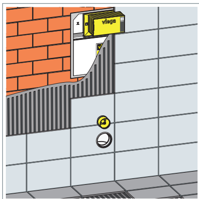
Фиг. 53: Общ монтаж на казанче Prevista Pure модел 8502 в комбинация с тоалетна
